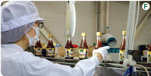
次の工程に流れていく様子(写真D)。目視検査。背後から光を当てながら、量の外観確認、またビンに傷がないかなどをチェックしていきます(写真E)。賞味期限を印字しラベルを貼ったら、賞味期限の印字が正しいか、ラベルがまっすぐ貼られているかを確認。このあと箱詰め、重量検査を経て、出荷まで倉庫で保管します(写真F)。
