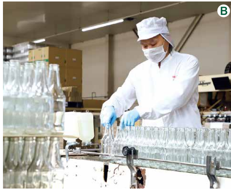
調査室。大量生産に対応するための巨大なタンクが並んでいます(写真A)。ビン詰め作業に入る前に、ビンを洗浄してから使用します(写真B)。規定の量になるように充填し、ふたをしていきます(写真C)。
