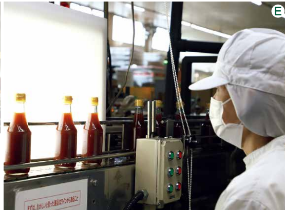
次の工程に流れていく様子(写真D)。目視検査。背後から光を当てながら、量の外観確認、またビンに傷がないかなどをチェックしていきます(写真E)。賞味期限を印字しラベルを貼ったら、賞味期限の印字が正しいか、ラベルがまっすぐ貼られているかを確認。このあと箱詰め、重量検査を経て、出荷まで倉庫で保管します(写真F)。
